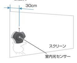
投影画像の端から 30cm を目安としてスクリーン に接触させるように室内 光センサー側がプロジェ クター側を向くように設 置してください。
