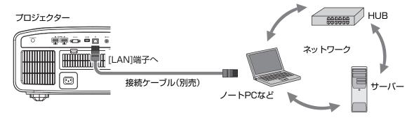
プロジェクターとネットワーク接続機器(ハブなど)をLANケーブルで接続します。
