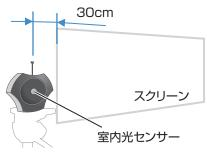
光学センサーは、プロジェク ターからの直接の光が当たら ない位置(投影画像の端から 外側に 30cm が目安)に光学 センサーをスクリーンに平行 にした状態で室内光センサー 側がプロジェクター側を向く ように設置してください。
